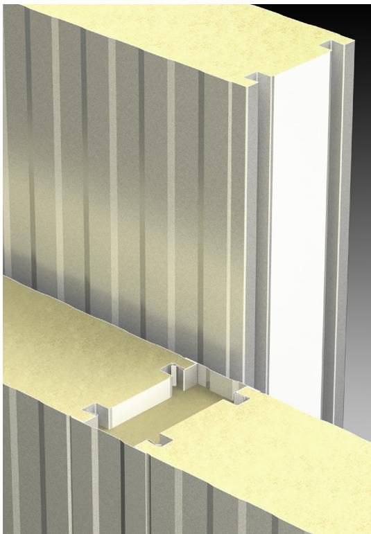
I pannelli sandwich modulari sono composti da rivestimenti in metallo e da un'anima interna in resine poliuretaniche espanshe. In figura: pannelli con giunto schiumato, ideali per ambienti refrigerati anche a bassissima temperatura.
